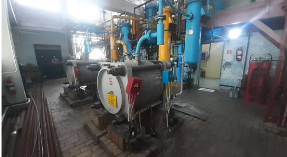
Усыг электролизийн аргаар задлах СЭУ-10х2 төхөөрөмж
